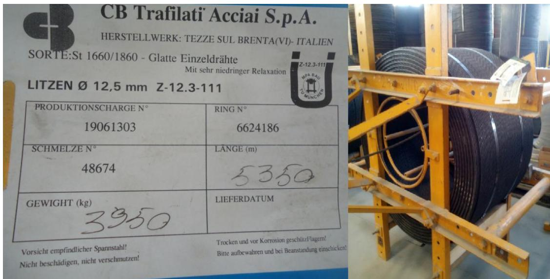
Slika 4.2 Karakteristike čeličnog užeta
