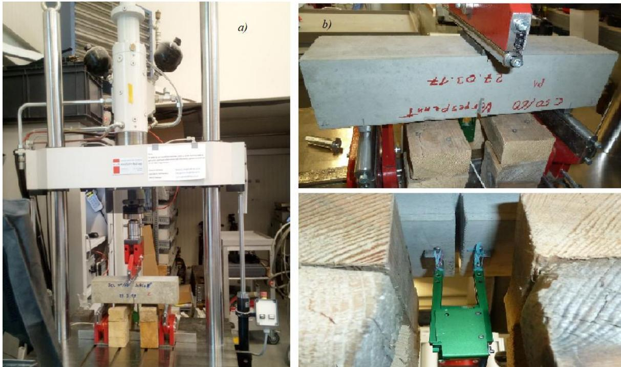
Slika 4.34 a) uređaj za testiranje; b) uzorak za vrijeme ozvođenja testa; c) mjerni uređaj (senzor)
