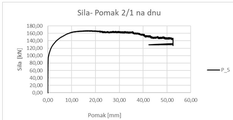
Slika 4.26 Odnos sile izvlačenja i pomaka 2/1 mjereno pomoću LVDT na dnu
