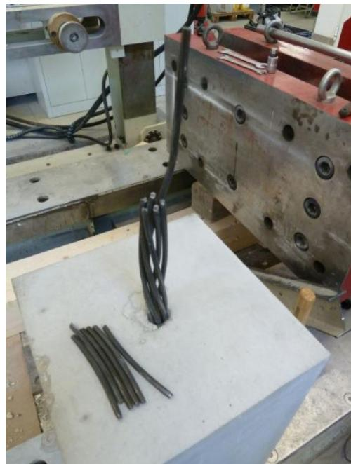
Slika 4.21 Izgled užeta nakon pojedinih testova
