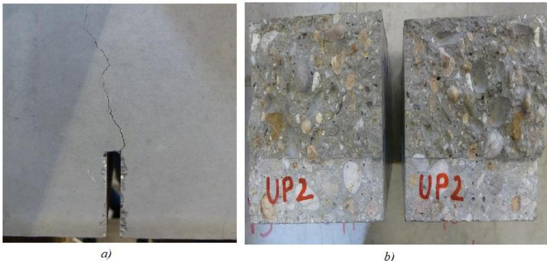
Slika 4.35 a) Pukotina na uzorku b) Prepolovljeni uzorak
