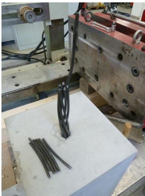
Slika 4.21 Izgled užeta nakon pojedinih testova
