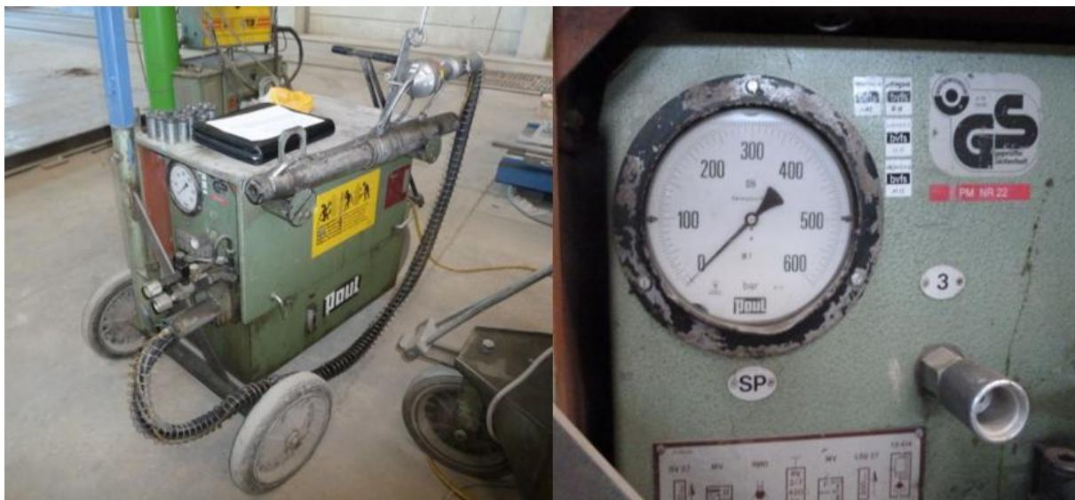
*Slika 4.6. Hidraulički uređaj za prenapinjanje*
