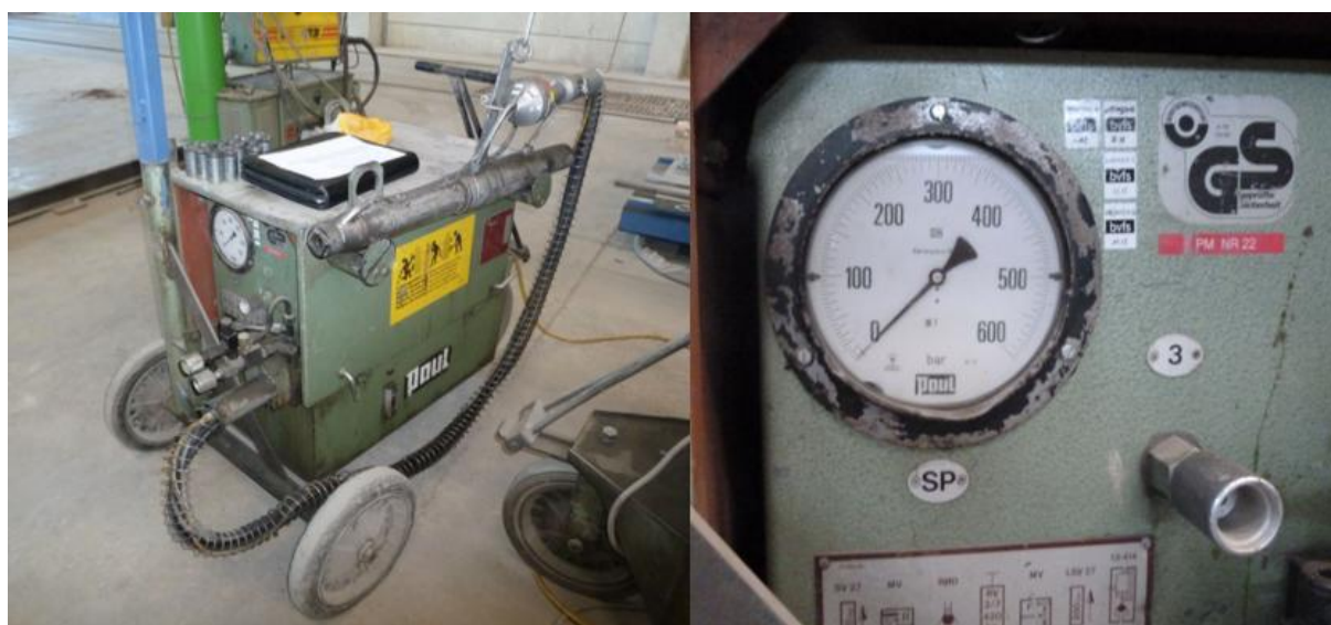
Slika 4.6. Hidraulički uređaj za prednapinjanje
