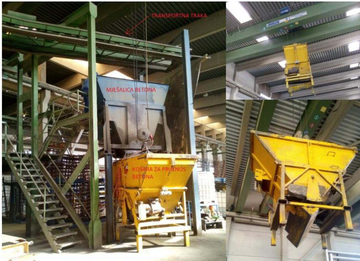
Slika 4.4 Priprema betonske mješavine te transport
