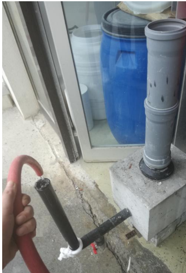
Slika 4.9 Ispitivanje propusnosti metodom padajuće razine stupca vode
