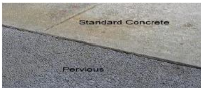
Slika 3.1 Usporedba poroznog i običnog betona [17]
