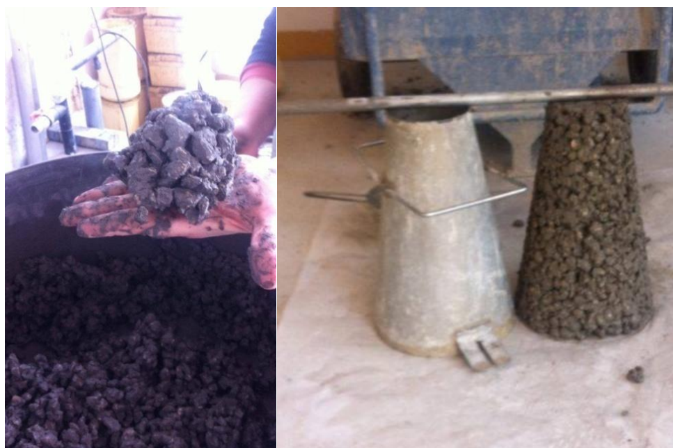
Slika 5.4 Ispitivanje konzistencije mješavine P 4
