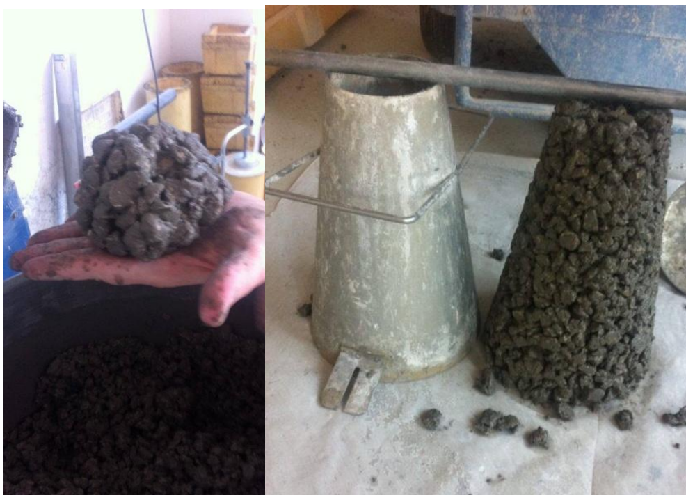
Slika 5.9 Ispitivanje konzistencije mješavine P 8 .
