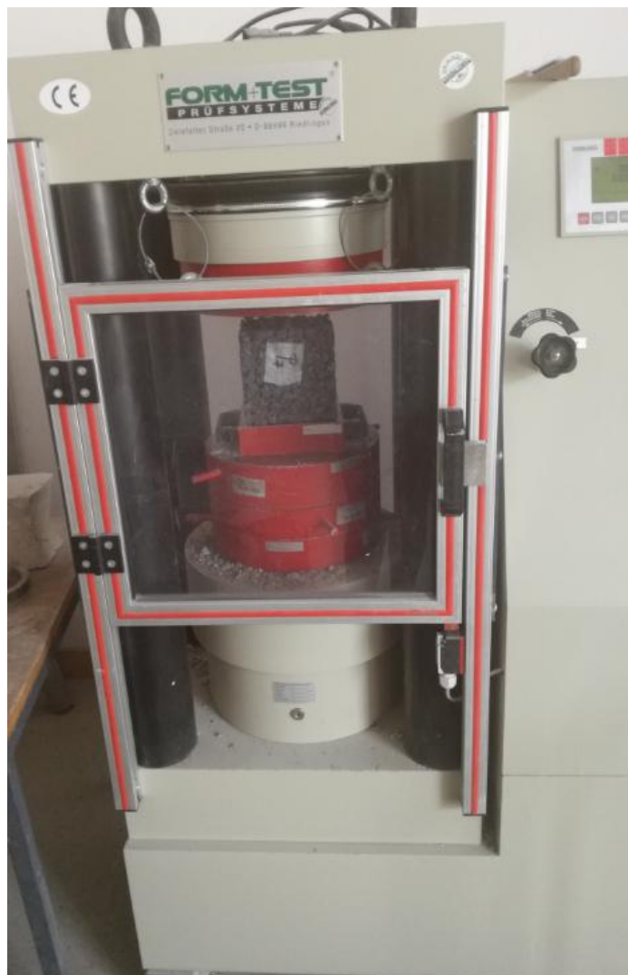
Slika 4.11 Ispitivanje tlačne čvrstoće hidrauličkom prešom
