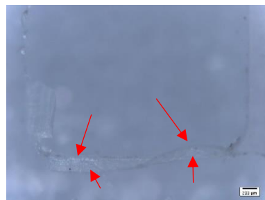
Slika 6.10 Mikroskopska snimka POM-a, mehaničko graviranje, rubni dio kvadratnog oblika
