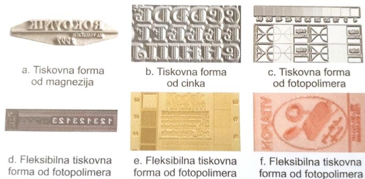
Slika 4.5 Različiti tipovi tiskovnih formi za visoki tisak[7]
