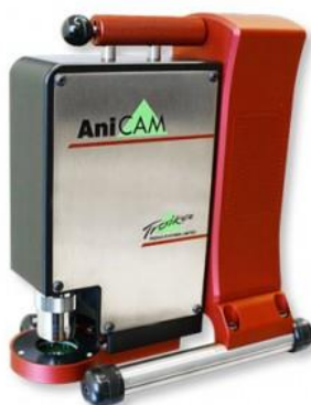
Slika 5.9 3D skenirajući mikroskop
