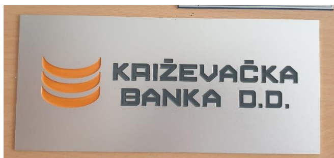
Slika 3.3 Obrada mehaničkim graviranjem s ispunom boje
