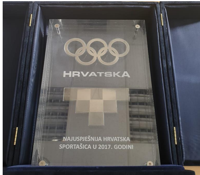
Slika 3.2 PLEXIGLAS (3 sloja)- kombinacija laserskog i mehaničkog graviranja
