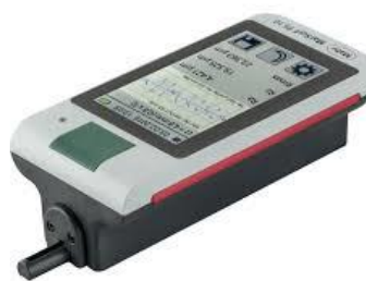
Slika 5.7 Uređaj za mjerenje hrapavosti površine
