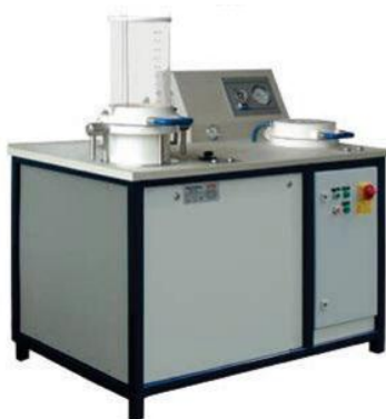
Slika 3: Stroj za izradu laboratorijskog papira Frank – PTI Rapid Köthen Sheet Machine [9]
