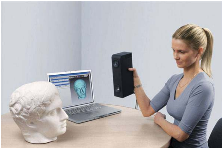
Slika 11. Primjer 3D skeniranja
