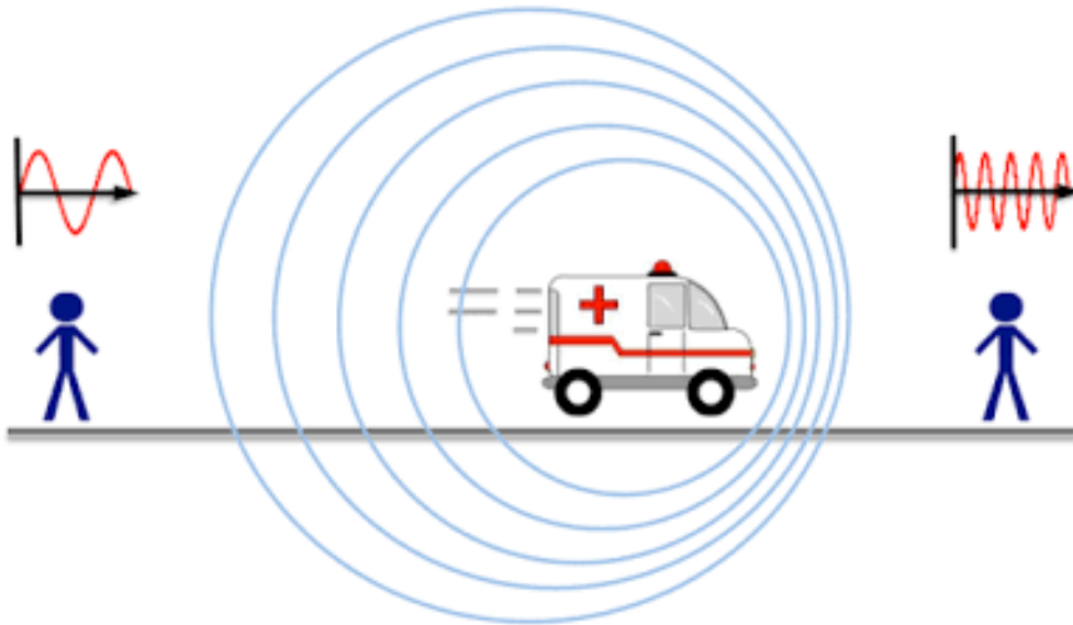
Slika 16: Ilustracija Dopplerovog efekta
