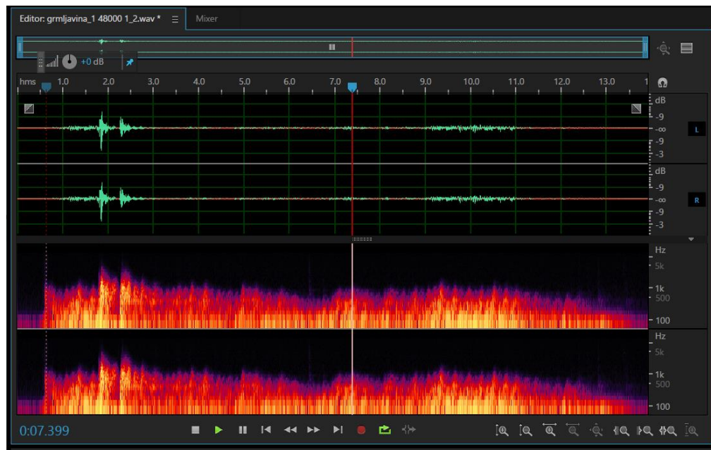
Slika 54: valni i spektralni prikaz snimljenog zvuka lima nakon primjenjivanja efekata Multiband Compressor, Parametric Equalizer i Stretch and Pitch
