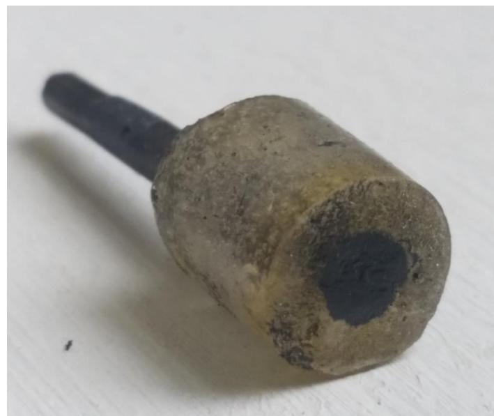
Slika 12. 20E24 CNT tenzidni senzor
