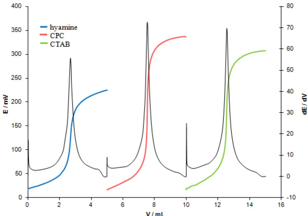
Slika 16. Prikaz potenciometrijskih titracijskih krivulja i prvih derivacija natrijevog dodecil sulfata i kationskih tenzida odnosno titranata, Hyamine, CPC i CTAB. Senzor je bila CNT ion-selektivna elektroda.
