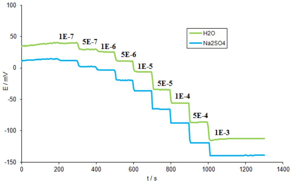
Slika 15. Dinamički odziv DS-a u deioniziranoj vodi i otopini natrijevog sulfata
