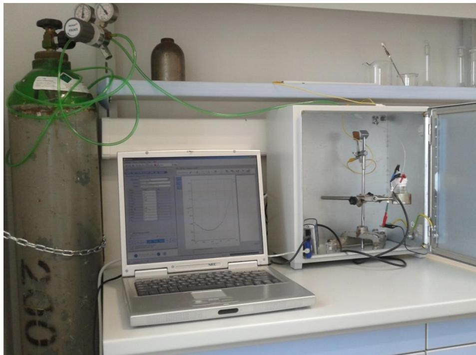
Slika 4. Prikaz aparature korištene za diferencijalnu pulsnu voltametriju.
