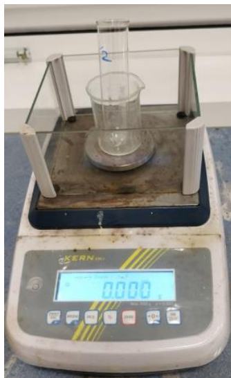
Slika 16.: Čaša s epruvetom u kojoj se važe žumanjak
