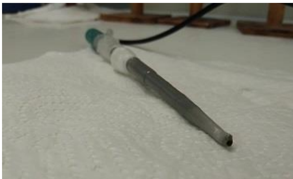
Slika 14. Tijelo DDA-TPB_B elektrode.
