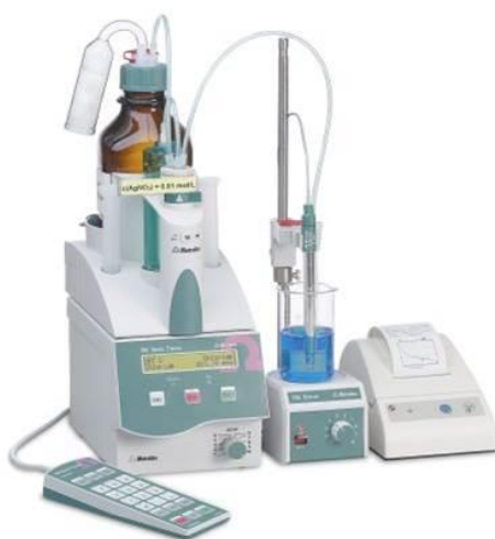
Slika 12. Automatski sustav za doziranje (794 Basic Titrino) [29].
