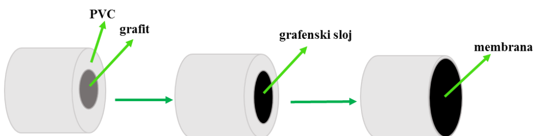
Slika 16. Shema indikatorske elektrode.
