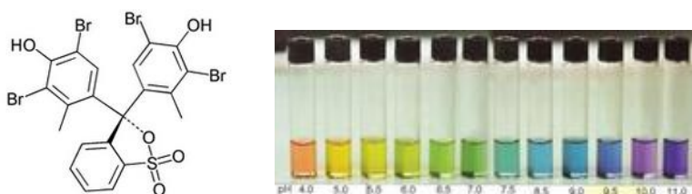
Slika 12. Struktura i boje bromkrezola pri različitim pH vrijednostima [30, 31].
