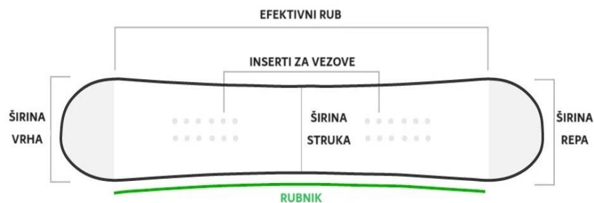
Slika 11. Prikaz dijelova daske za daskanje na snijegu
