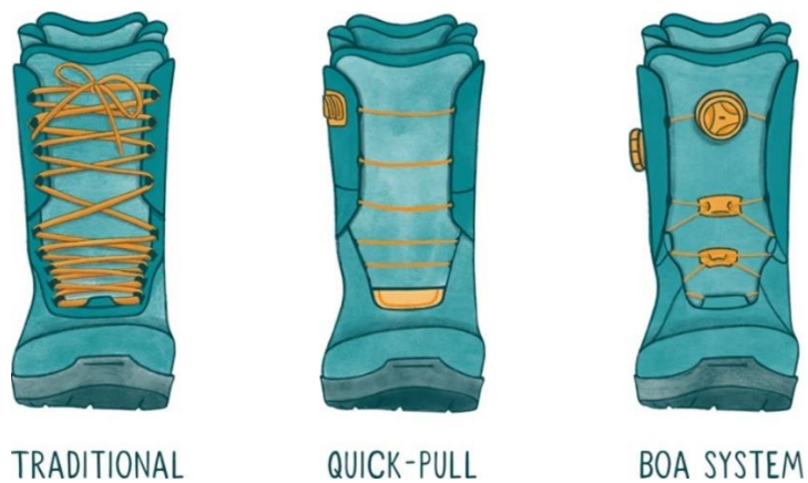
Slika 17. Različiti sistemi zatezanja cipela za daskanje na snijegu
