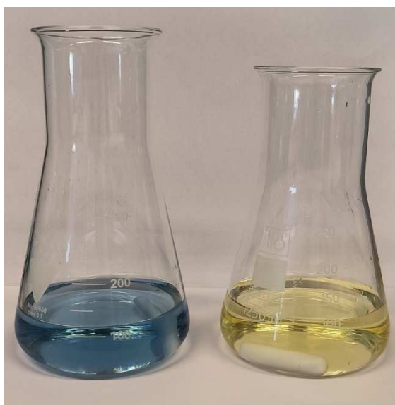
Slika 2.2. Prikaz prijelaza boje pri kompleksometrijskoj titraciji u točki ekvivalencije.
