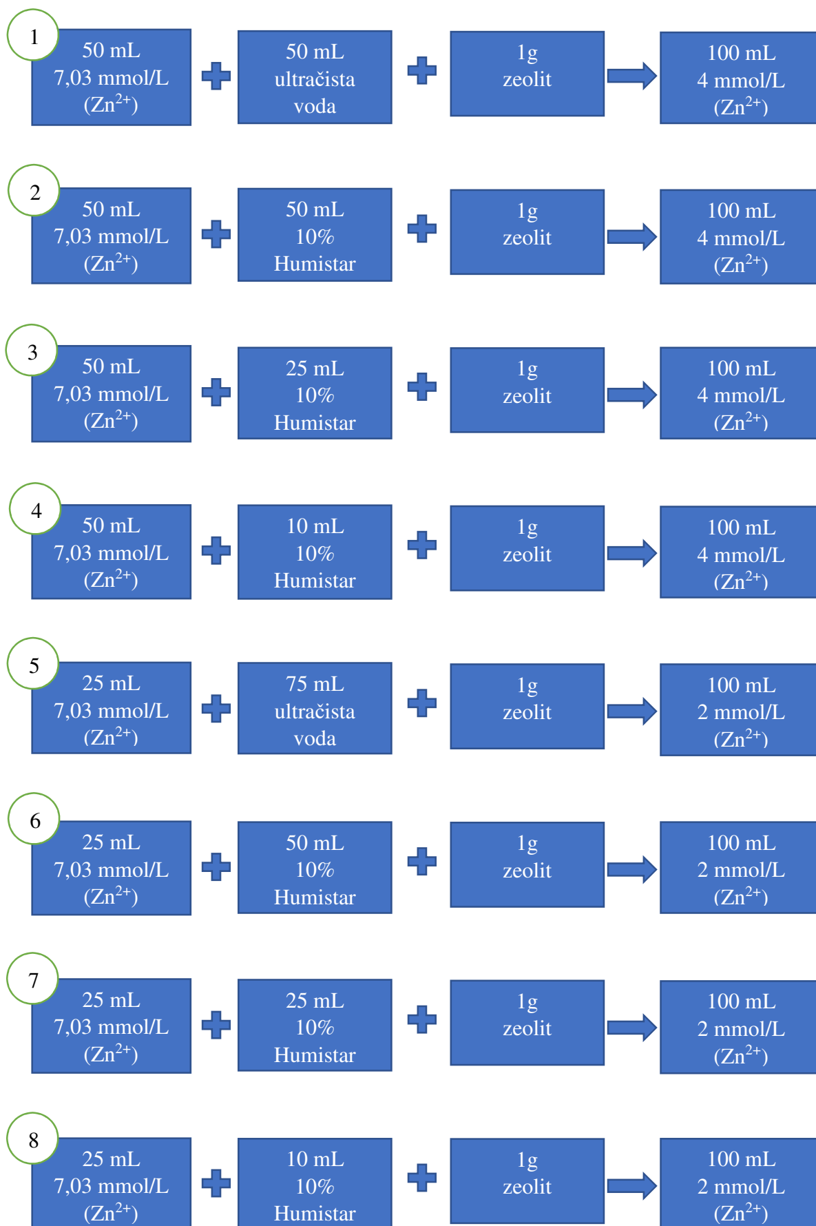
Slika 2.9. Shema eksperimenta vezanja iona cinka na zeolitu uz različite dodatke otopine Humistar®.
