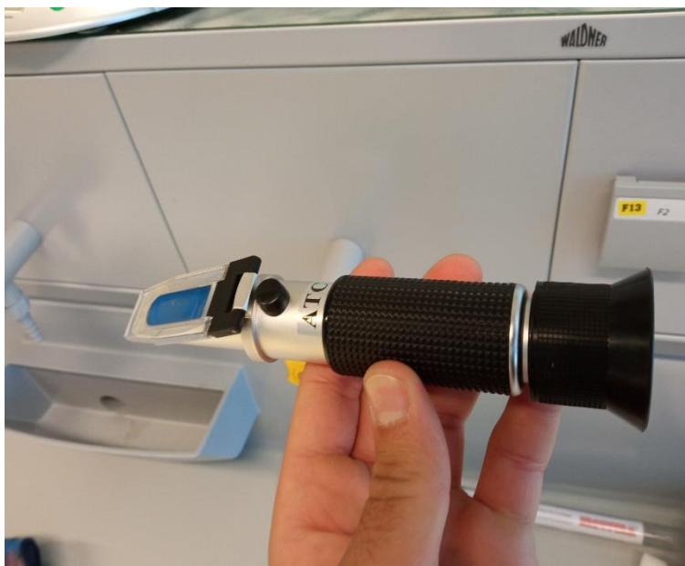
Slika 13. Određivanje sadržaja šećera refraktometrom
