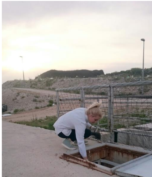
Slika 2.2 Uzorkovanje procjedne vode iz egalizacijskog bazena.
