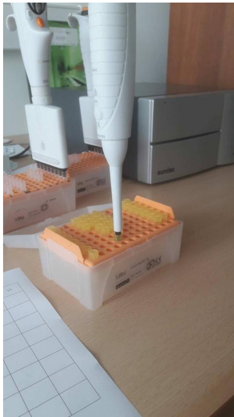
Slika 23. Mikropipete i višekanalni čitač mikrotitarskih pločica "Sunrise" (Tecan, GmbH, Austrija)
