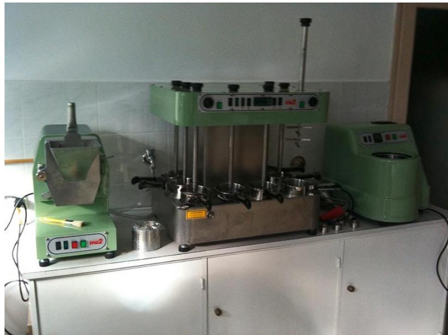
**Slika 16.** Laboratorijska uljara Abencor mc2
