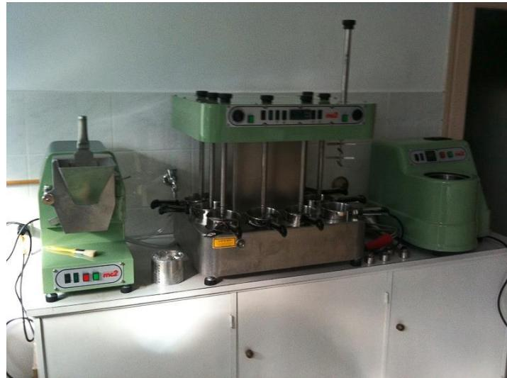
**Slika 12.** Laboratorijska uljara Abencor mc2
