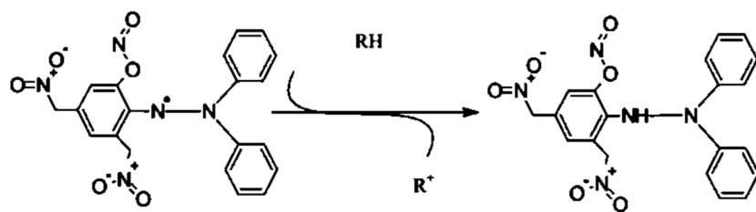
Slika 8. Mehanizam reakcije DPPH radikala s antioksidansom<sup>18</sup>
