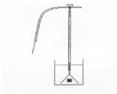
Slika 15. Aparatura za mjerenje volumena razvijenog vodika 20
