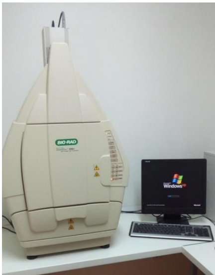
Slika 29: Uređaj za snimanje s tamnom komorom (ChemiDoc TM XRS+ System)
