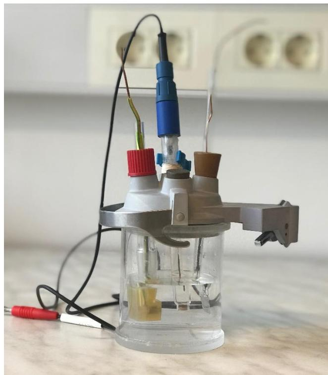
**Slika 3.1.** Slika elektrokemijskog reaktora.
