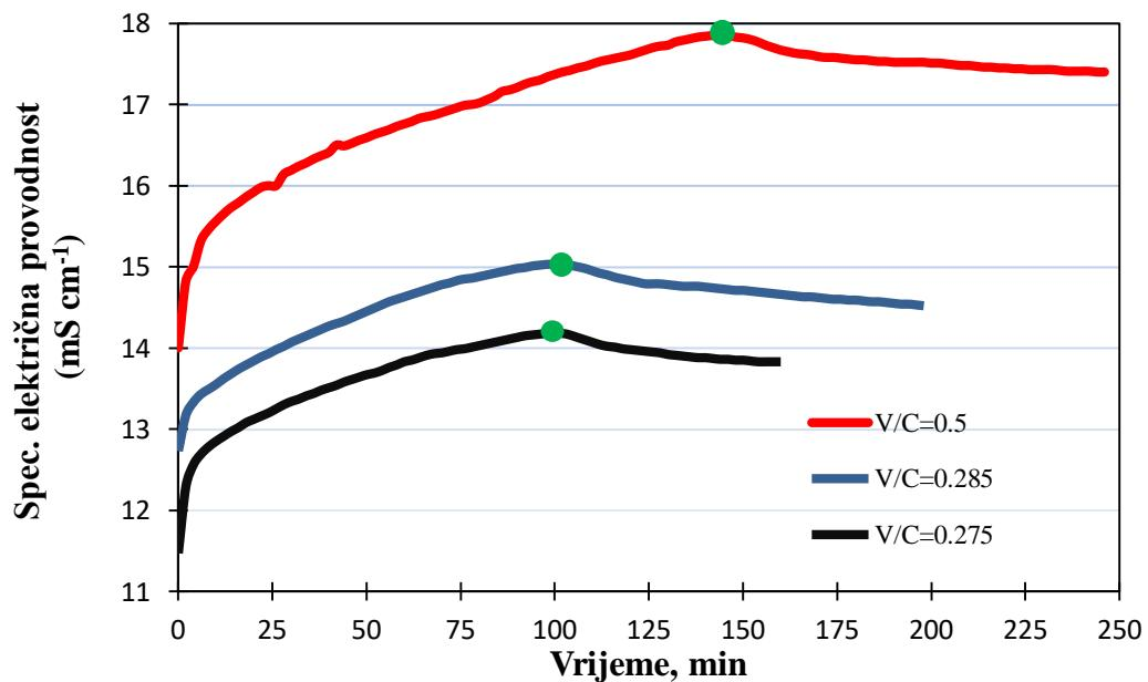
**Slika 10.** Grafički prikaz specifičnih električnih provodnosti cementnih pasti u ovisnosti o vremenu hidratacije za vodo cementne omjere:  $V/C = 0,5, 0,285, 0,275$  pri  $T = 20^\circ\text{C}$ .
