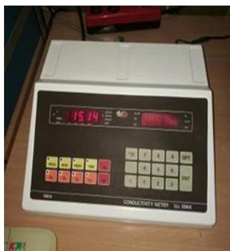
**Slika 5.** Konduktometar Iskra MA 5964
