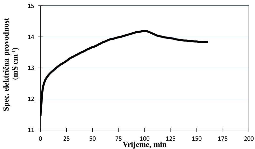
**Slika 9.** Specifična električna provodnost cementne paste u ovisnosti o vremenu hidratacije za vodo cementni omjer 0,275 i  $T = 20^\circ\text{C}$ .
