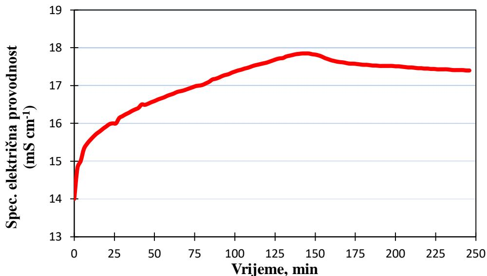
Slika 7. Specifična električna provodnost cementne paste u ovisnosti o vremenu hidratacije za vodocementni omjer 0,5 i  $T = 20^\circ\text{C}$ .
