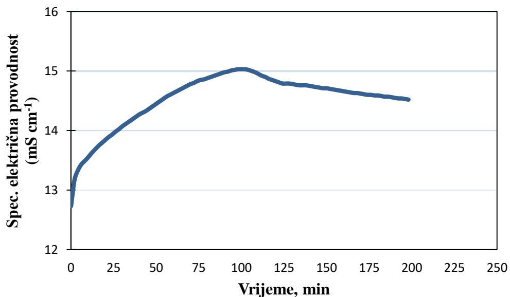
Slika 8. Specifična električna provodnost cementne paste u ovisnosti o vremenu hidratacije za vodocementni omjer 0,285 i  $T = 20^\circ\text{C}$ .
