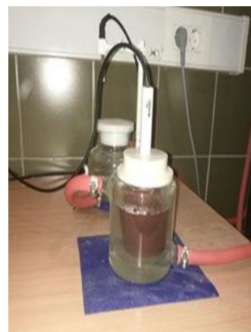
**Slika 6.** Mjerna posuda s uzorkom i uronjenom elektrodom
