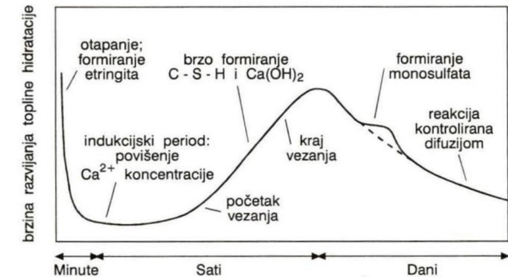
Slika 2. Shematski prikaz brzine razvijanja topline hidratacije<sup>1</sup>
