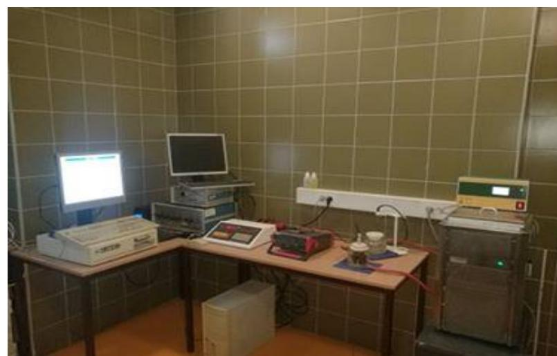
**Slika 4.** Aparatura za provedbu konduktometrijske metode
