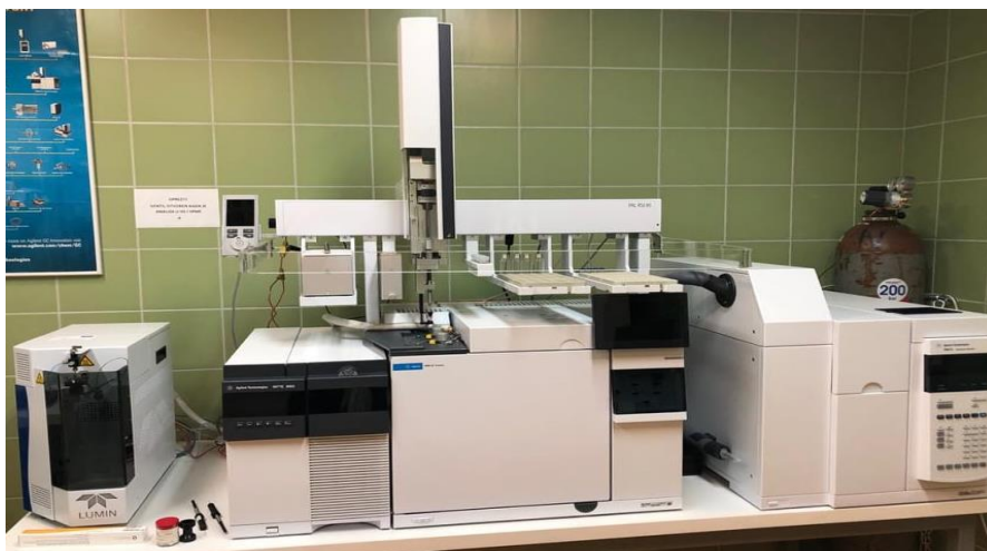
Slika 15. Vezani sustav plinska kromatografija i spektrometrija masa (50)
