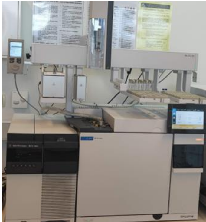
Slika 11. Plinska kromatografija sa spektrometrijom masa (GC-MS)
