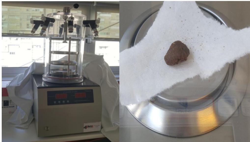
Slika 17. Liofilizator i liofilizirani uzorak crvenog luka
