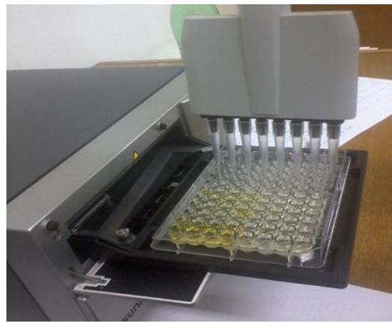
**Slika 21.** Poluautomatska pipeta i višekanalni čitač mikrotitarskih pločica "Sunrise"<sup>10</sup>
