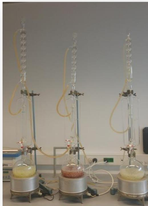
**Slika 16.** Aparatura za destilaciju po Clevengeru
