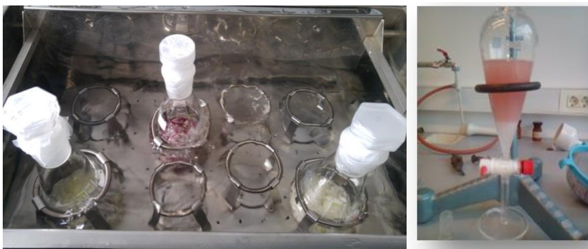
Slika 18. Autoliza na vodenoj kupelji i ekstrakcija
