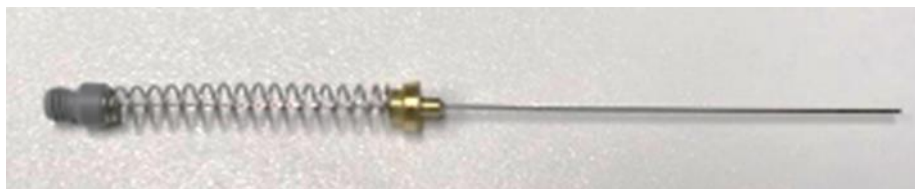
Slika 24. Sivo vlakno (vlakno s ovojnicom DVB/CAR/PDMS) za HS-SPME (Izvor: autor)
