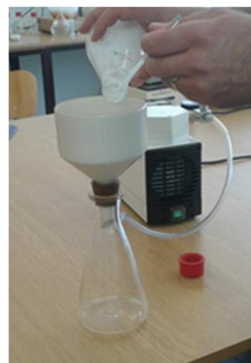
**Slika 13.** Ispiranje uzorka ultračistom vodom i filtracija kroz Büchnerov lijevak
