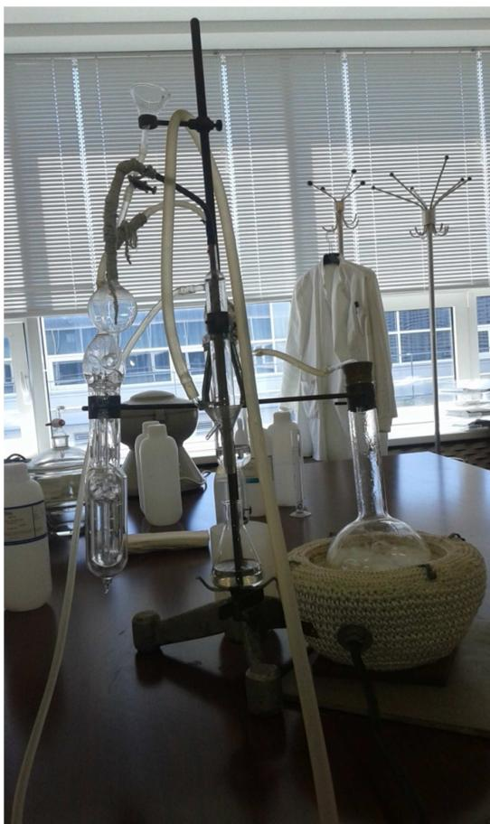
**Slika 15.** Aparatura za mikrodestilaciju po Kjeldahlu
