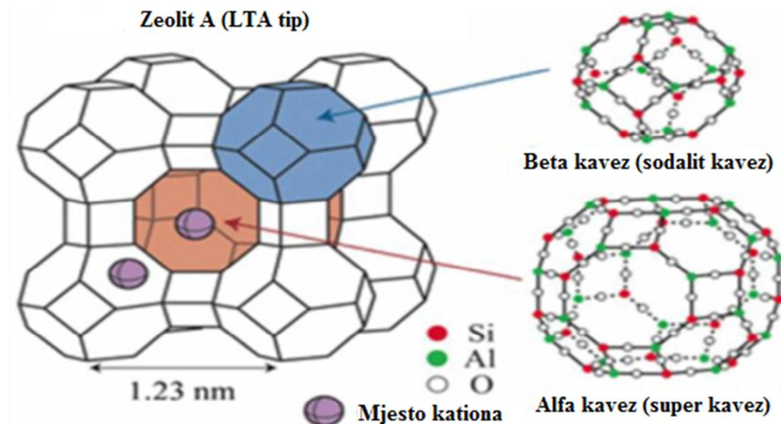
**Slika 4.** Prikaz strukture zeolita A<sup>6</sup>
