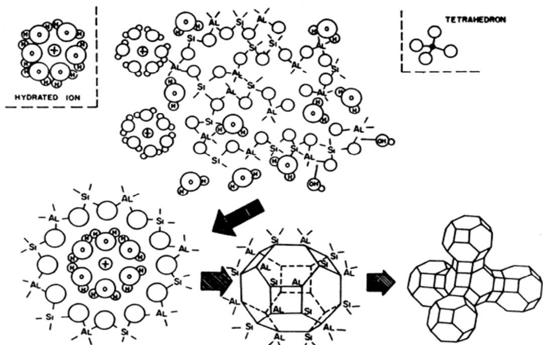
**Slika 6.** Mehanizam nastajanja zeolita prema Brecku i Flanigenu
