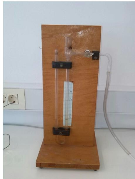
**Slika 16.** Blaine-ov zračni permeabilimetar
