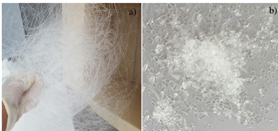
Slika 9. Polilaktidna kiselina: a) vlakna, b) usitnjena vlakna
