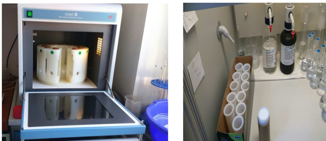
Slika 13. Razaranje uzoraka tla u mikrovalnoj peći
