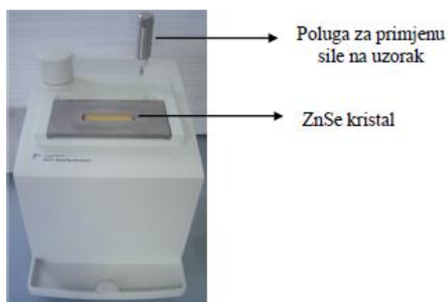
Slika 20. Dodatak za snimanje uzorka HATR tehnikom
