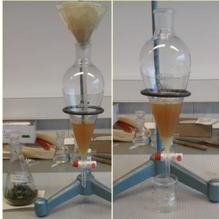
Slika 30. Ekstrakcija s diklormetanom.
