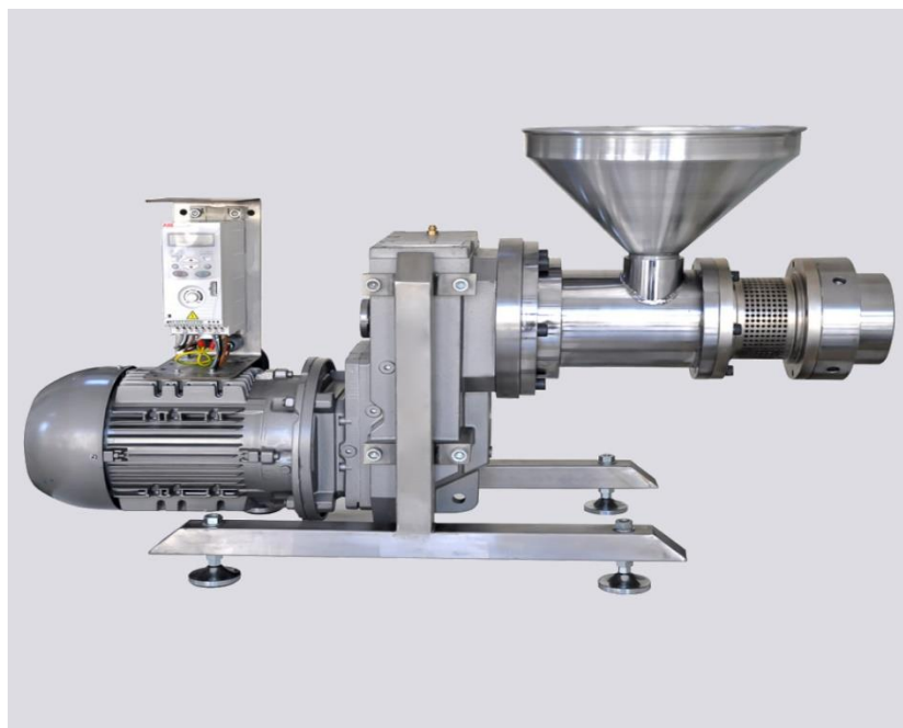
Slika 5. Stroj za hladno prešanje ulja (10)
