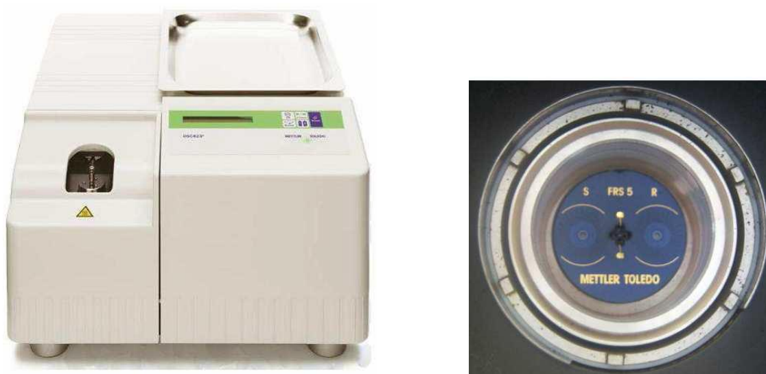
Slika 18. a) Diferencijalni pretražni kalorimetar DSC 823 e (Mettler Toledo, Švicarska) i b) mjerno osjetilo
