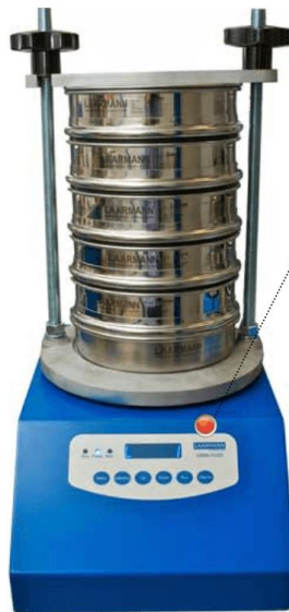
Slika 15. Uređaj za provedbu analize pomoću sita.
