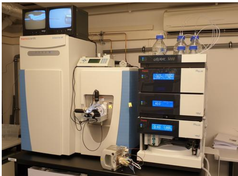
Slika 8. Vezani sustav tekućinska kromatografija - spektrometrija mase (LC-ESI-MS-MS), izvor: https://www.biosupramol.de/en/Massenspektrometrie/BioMS/Geraete/LC-ESI-MS.html
