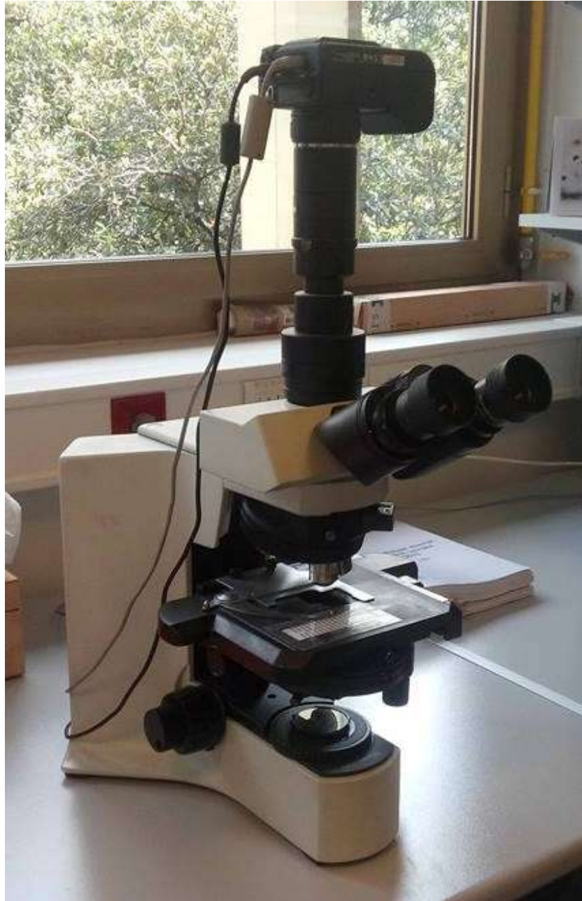
Slika 19. Mikroskop Olympus BX41 s priključenim fotoaparatom za fotografiranje uzoraka
