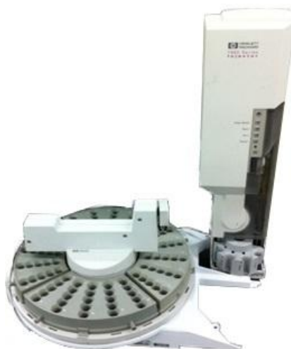
Slika 1.6. Automatski uzorkivač Agilent 7683 (14).
