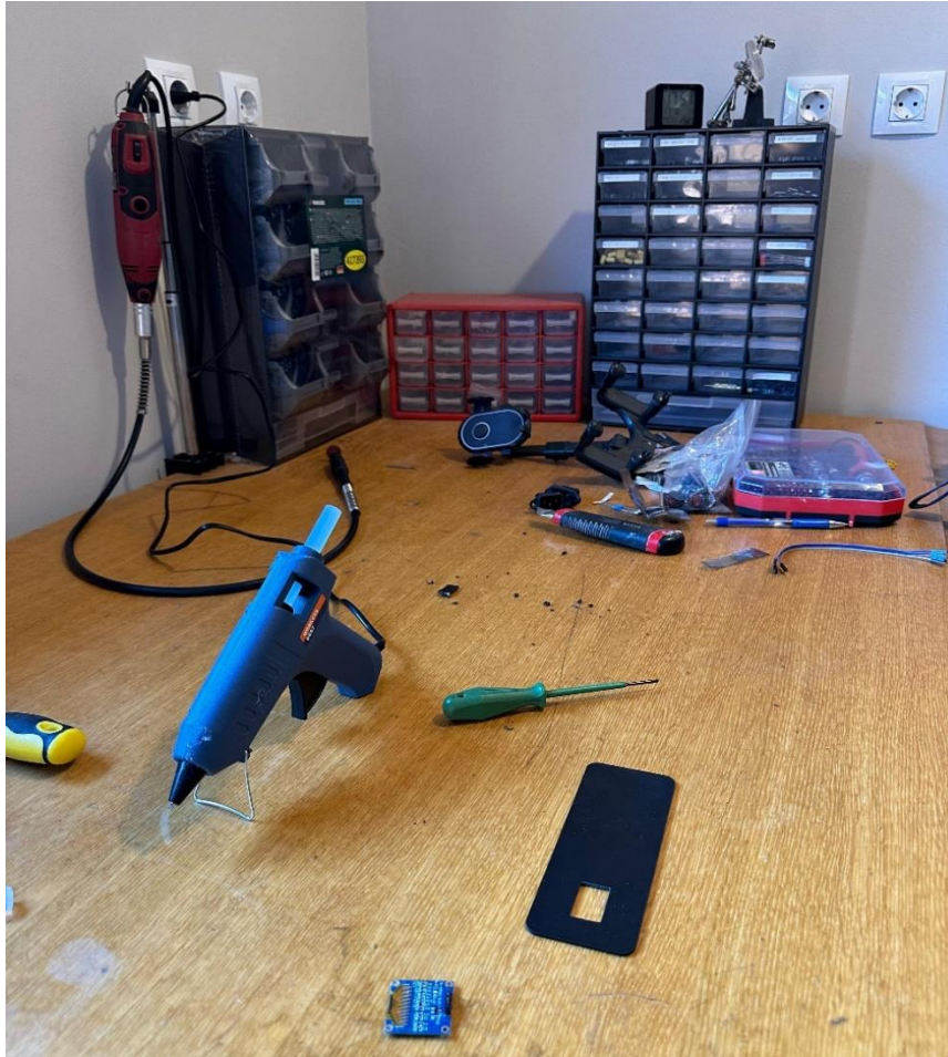
Slika 36. Priprema za lijepljenje OLED zaslona na izrezani otvor Izvor: Autor
