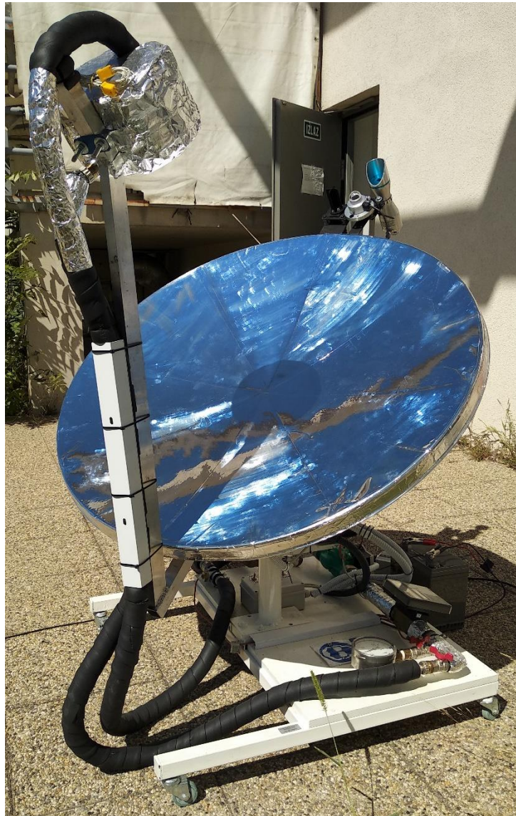
Slika 3.2. – Sjena od grijača stvorena na površini prilikom rada solarnog tanjura
