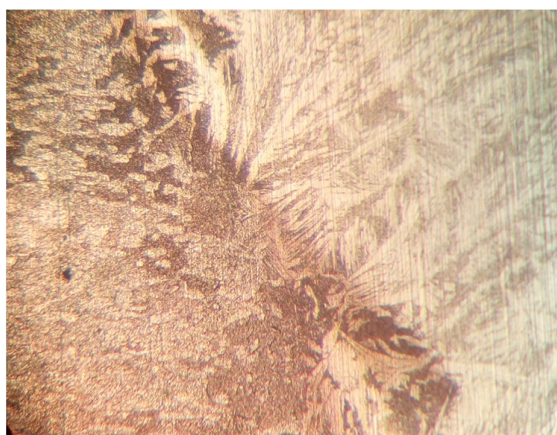
Slika 29. Mikrostruktura u zoni utjecaja topline [30]
