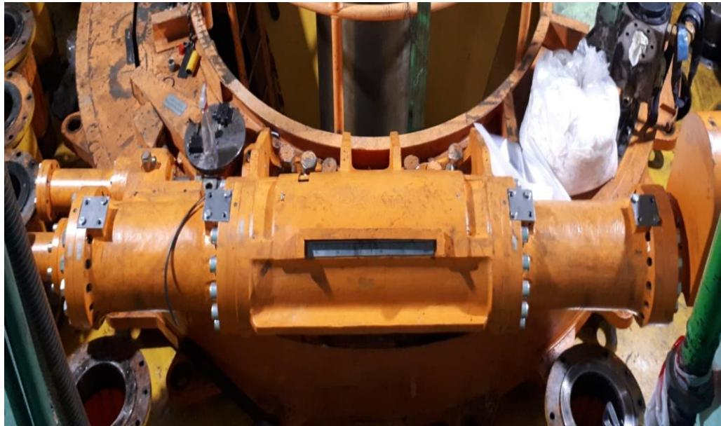
Slika 4. 25. Servo motor privodnog aparata [15]
