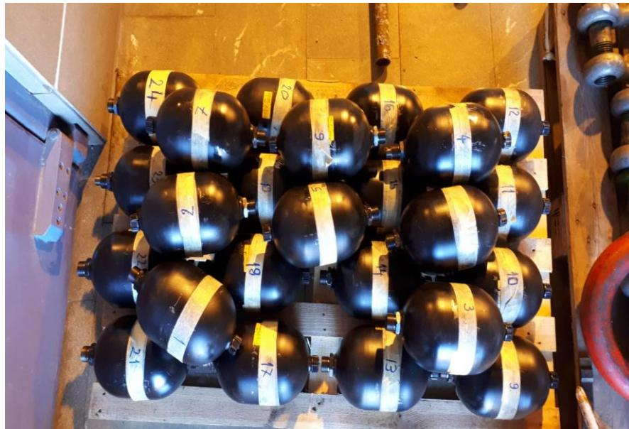
Slika 4. 26. Hidraulički akumulatori [15]
