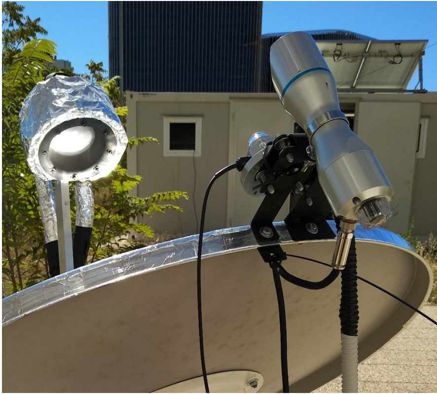
Slika 4.3. – Piranometar i pirheliometar u radu
