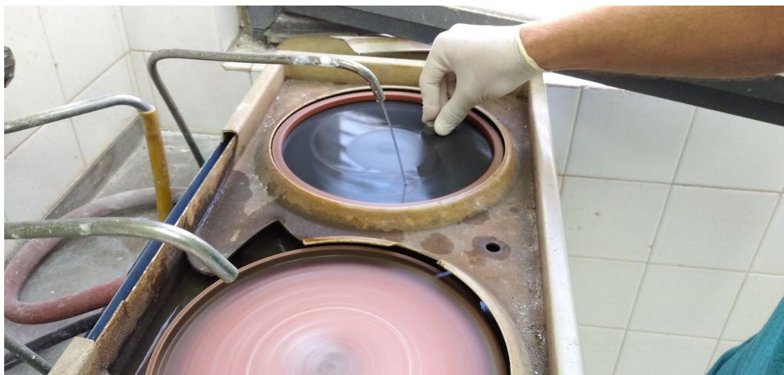
Slika 24. Brušenje uzorka na brusilici s kružnom brusnom pločom [30]
