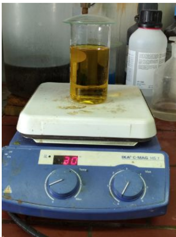
Slika 31. Magnetska miješalica s grijaćom pločom te posuda s otopinom i uzorkom u njoj [30]
