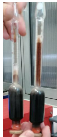
Slika 12. Prikaz karamelizirane laktoze koja daje karakteristično obojenje nakon dodatka amilnog alkohola u sladolednu smjesu (Ledo plus d.o.o. vlastita fotografija, 2021)
