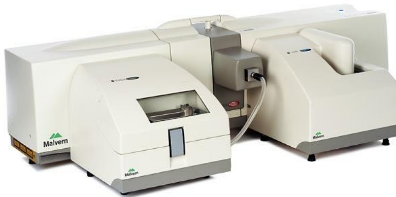
Slika 5. Uređaj za određivanje veličine čestica Malvern Panalytical Mastersizer 2000 (Anonymous 2)
