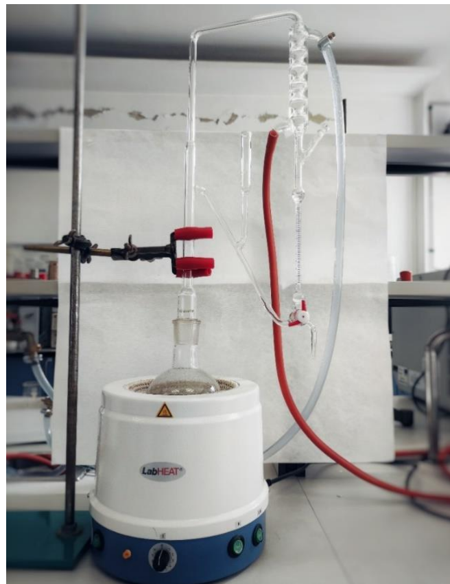
Slika 8. Aparatura po Clevengeru (vlastita fotografija)
