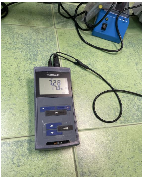
Slika 2. Laboratorijski pH-metar WTW-ProfiLine pH 3110 tvrtke Xylem Analytics (Weilheim, Njemačka (vlastita fotografija)
