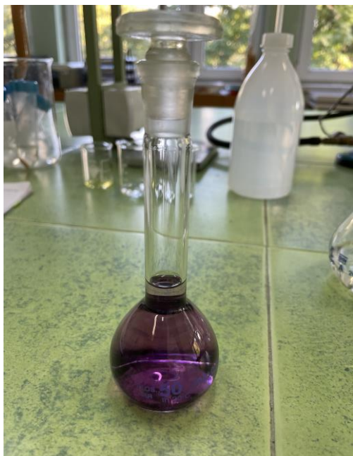
Slika 3. Svježe pripremljen DPPH reagens (vlasita fotografija)
