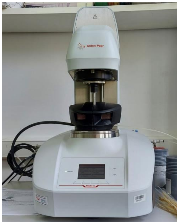
Slika 3. Reometar za ispitivanje reoloških svojstava tijesta (vlastita fotografija)
