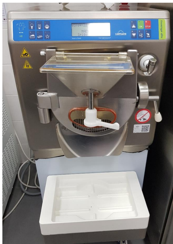
Slika 6. Carpigiani stroj za izradu zanatskog sladoleda (vlastita fotografija)
